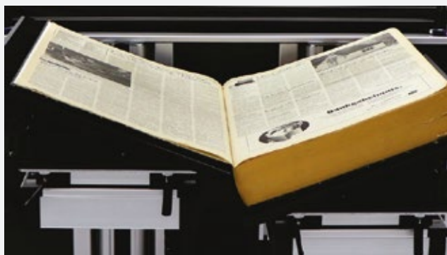
Сканирование книги с использованием защитной V-образной колыбели для хрупких сшитых документов.
